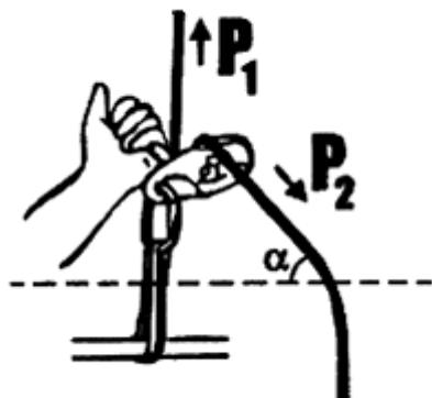
Использование спускового устройства
